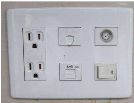
写真-6 60分加熱後コンセント状況 (非加熱側)
