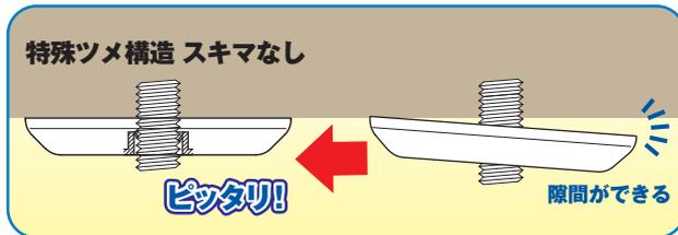
段差を設けて配置したツメ構造によりワンタッチで天井面が隙間のない仕上がりに
