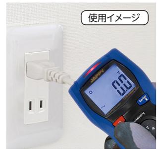
製品上部の検知部分が交流電圧(AC 100~600V)に反応し、本体の赤色LEDが点灯(非接触検電機能(NCV機能))
