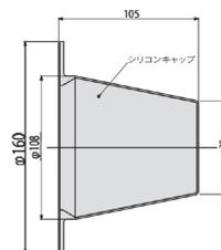
【特長】 ● きりこ 切粉の飛散を防止し、同時に回収 ● 素材：シリコンゴム
