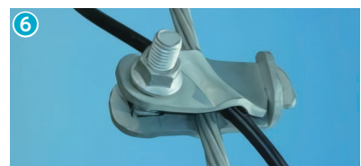
工具でナットをしっかりと締め付けます (締め付けトルク14N・m (1.4kgf・m))
