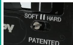
被切削材に合わせて締め込む
