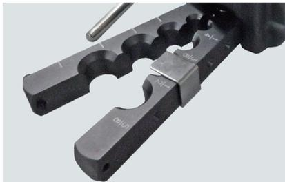
スライド式プランジャー位置決め機構とツラ出しアタッチメントで確実な加工を実現
