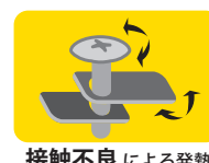
接触不良による発熱
