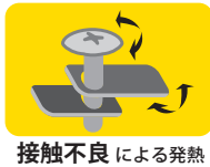
接触不良による発熱
