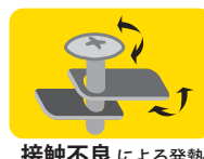
接触不良による発熱
