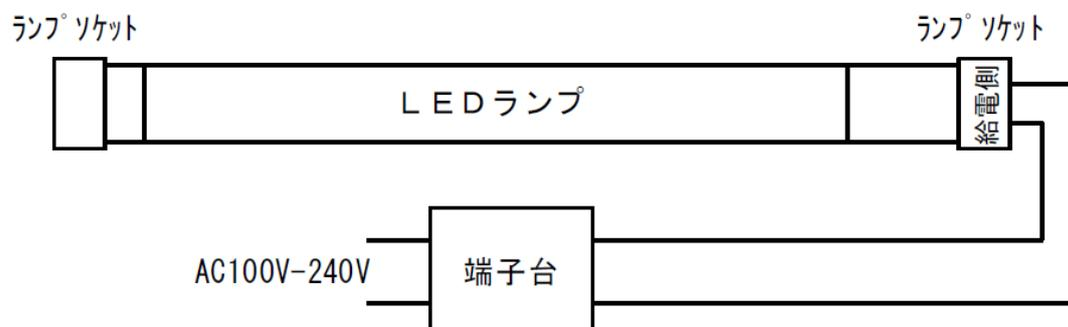
器具の施工には電気工事士の資格が必要です。施工は必ず工事店に依頼してください。
