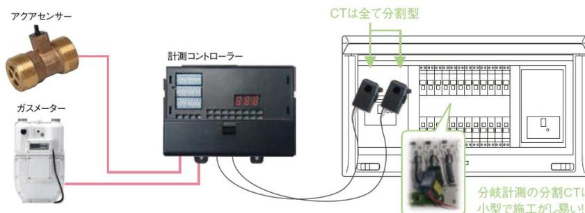
分電盤へのCT取付け型のため、集合住宅やリフォームにも最適。
