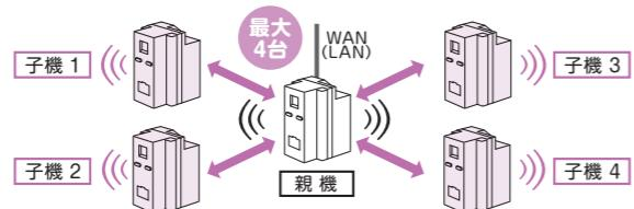
■親機と子機2が直接電波が届かない場合は、親機に接続している別の子機1を探し、子機1を経由して親機に接続します。
