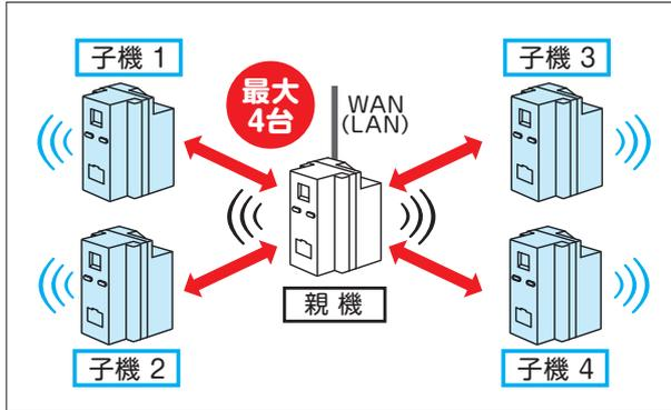
トラフィック発生時に子機の通信速度に影響が無いよう、親機が各機器の容量を確保します。
