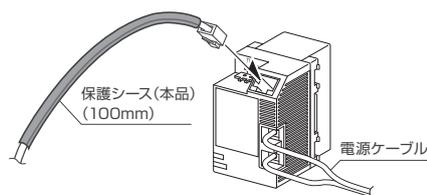
ケーブルの曲げによりシースが外れるもしくは固定されない場合は適宜、絶縁テープで止めてください。
