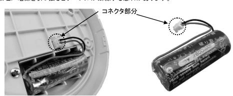
3) 新しい電池と交換し、中フタをかぶせて中ねじ(3箇所)で取り付けてください。
