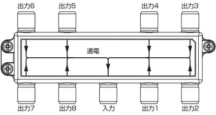
●通電容量 DC15V・0.8A以下(直流)専用
