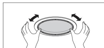
取り付け時：左右に回して磁石が止まる位置をさがす。
