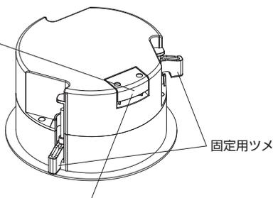
ⓧスピーカーコード接続端子台にAC100V電源コードを挿入しないようにご注意ください
